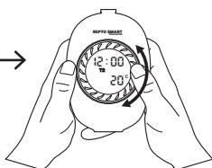
Drehen Sie den Hauptknopf im oder gegen den Uhrzeigersinn, um zwischen T1 und T8 zu wechseln.
