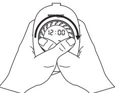
Drehen Sie die Haupttaste um 90° im Uhrzeigersinn, während Sie die Haupttaste gedrückt halten.
