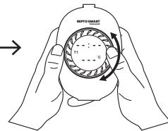
Draai de hoofdknop tegen de klok in (voorbij 00:00) om de instelling te verwijderen. De resterende tijdsperiodes worden opnieuw gerangschikt.
