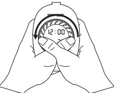
Drehen Sie die Haupttaste 90° gegen den Uhrzeigersinn, während Sie die Haupttaste gedrückt halten.
