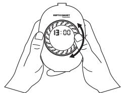
Drehen Sie den Hauptknopf im oder gegen den Uhrzeigersinn, um die Stunde einzustellen.
