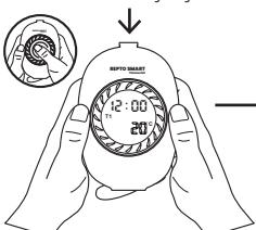
Drücken Sie die Haupttaste, um in die Phase der Temperatoreinstellung zu gelangen. Die Temperatur wird blinkend angezeigt.
