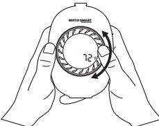
Tournez le bouton principal dans le sens des aiguilles d'une montre ou dans le sens inverse pour alterner entre "C" ou "F".
