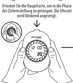
Drehen Sie den Hauptknopf im oder gegen den Uhrzeigersinn, um die Zeit um 30 Minuten zu erhöhen oder zu verringern. (00:00 bis 23:30).
