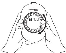
Tournez le bouton principal dans le sens des aiguilles d'une montre ou dans le sens inverse pour régler l'heure.
