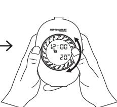
Tournez le bouton principal dans le sens des aiguilles d'une montre ou dans le sens inverse pour passer de T1 à T8.
