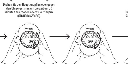
Wenn Sie auf die Position "OFF" drehen, wird Ihr Heizgerät ausgeschaltet.
