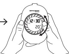
Tournez le bouton principal dans le sens des aiguilles d'une montre ou dans le sens inverse pour augmenter ou diminuer l'heure de 30 minutes. (00:00 à 23:30).
