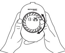
Tournez le bouton principal dans le sens des aiguilles d'une montre ou dans le sens inverse pour régler les minutes.
