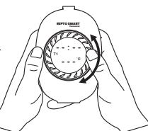
Drehen Sie den Hauptknopf gegen den Uhrzeigersinn (nach 00:00), um die Einstellung zu löschen. Die verbleibenden Zeiträume werden in der Reihenfolge neu angeordnet.
